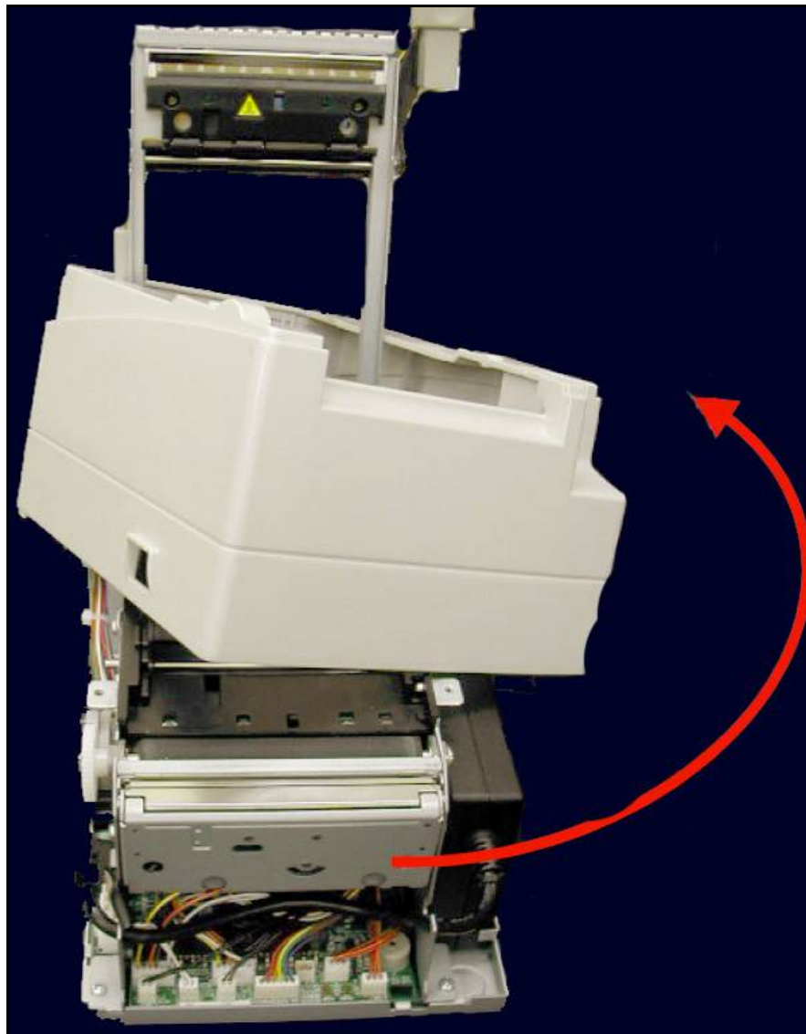
Рисунок 7 – Снятие кожуха принтера.
