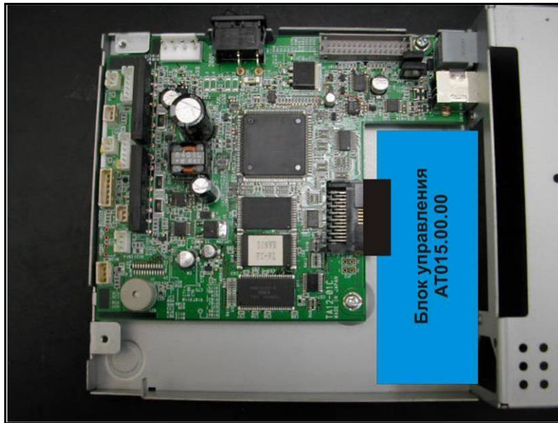
Рисунок 13 – Установка БУ в принтер.
