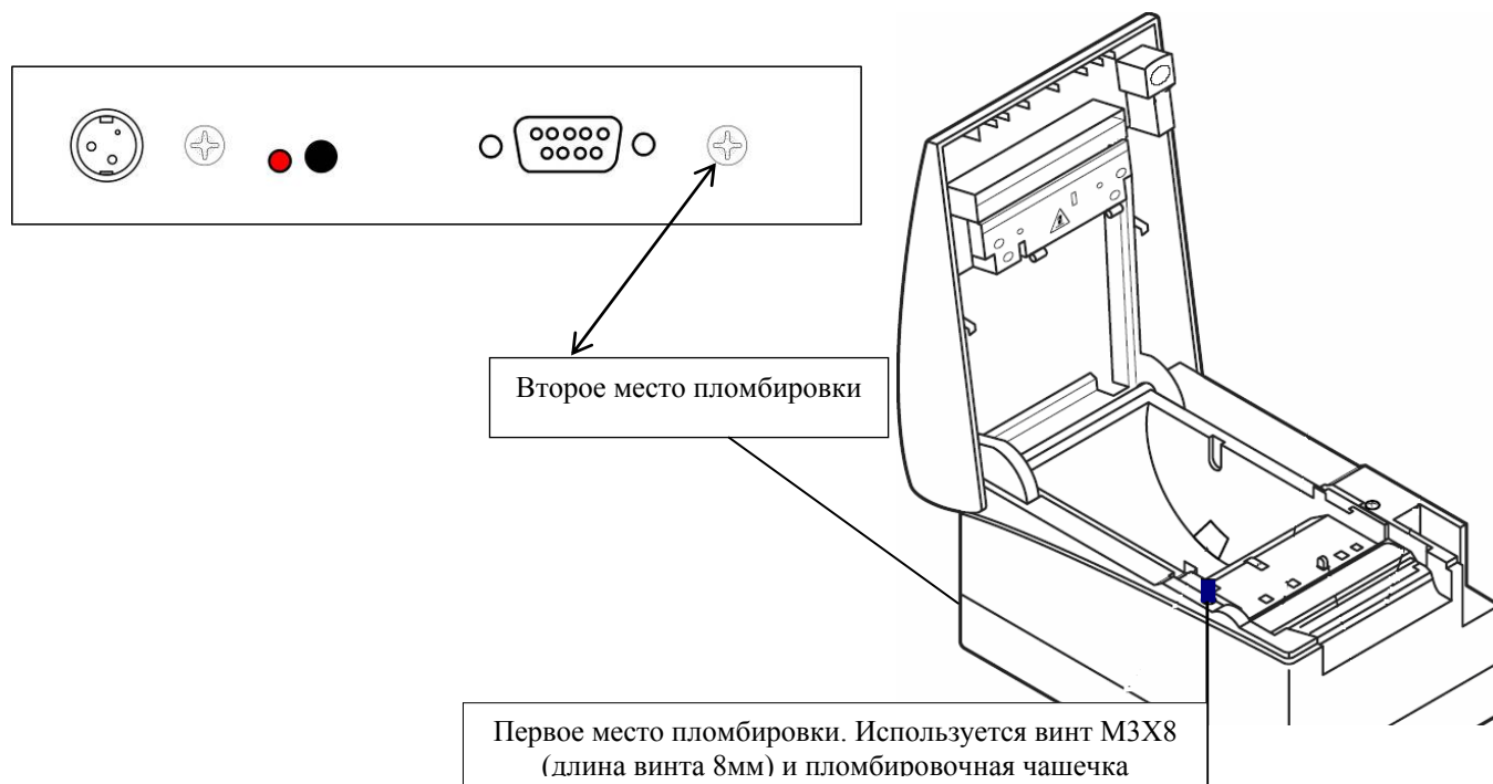
Рисунок 23 – Пломбировка ККМ (винт М3).
