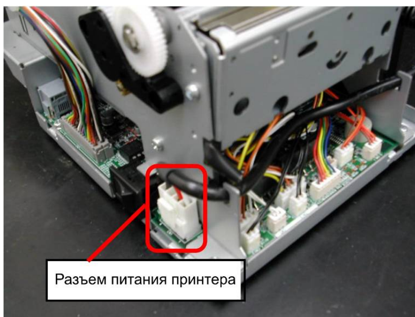
Рисунок 14 – Подключение питания принтера.
