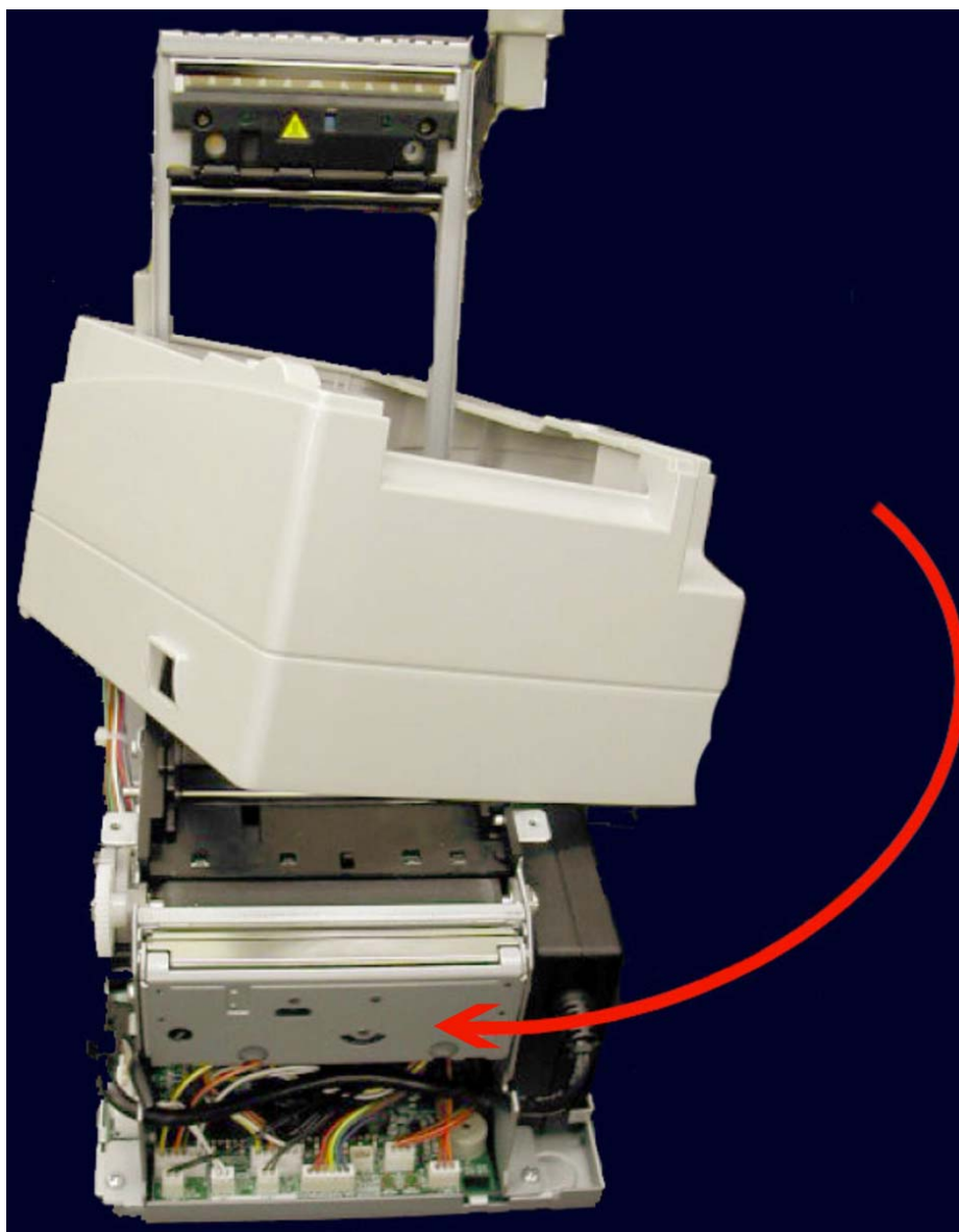
Рисунок 15 – Установка кожуха ККМ на печатающее устройство.
